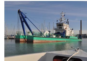
**- Rotodévaseur** : une fraise horizontale mécanique remet en suspension les sédiments qui sont transportés par les courants.
